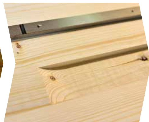
Sauber gearbeitet: Der Fräser hinterlässt glatte Kanten beim Ein- und AUSTAUCHEN
