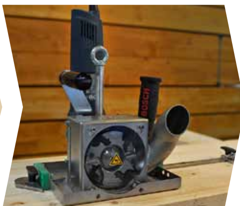
Mit der Fräse fabriziert der Holzkosmetiker eine 250 mm lange Nut in die Binderoberfläche
